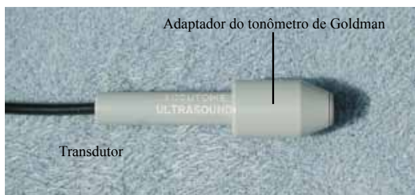
Figura 3-10 Transdutor com adaptador de tonômetro de Goldman
