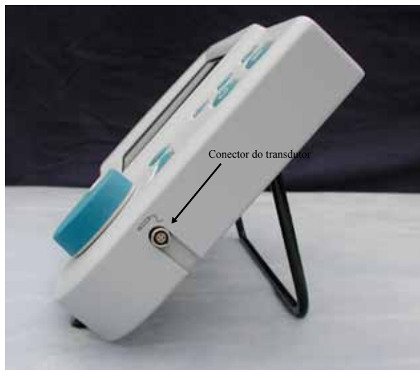
Figura 3-5 Conector do transdutor (lado direito do instrumento)
