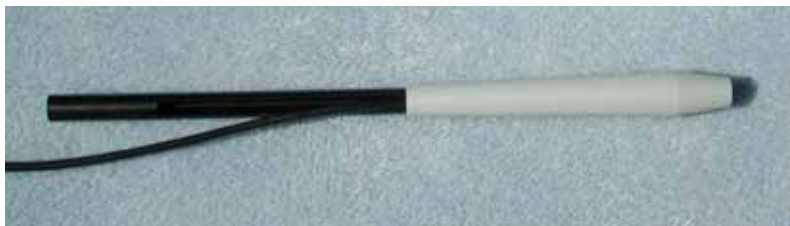
Figura 3-12 Transdutor com extensão de cabo e ferramenta de inserção
