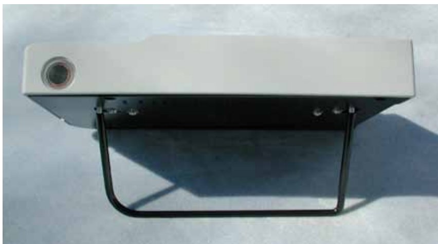
Figura 3-16 Bloco de teste do Accutome A- Scan Synergy (topo do instrumento)
