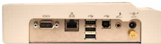
Figura 3-4 Conectores de componentes (lado esquerdo do instrumento)
