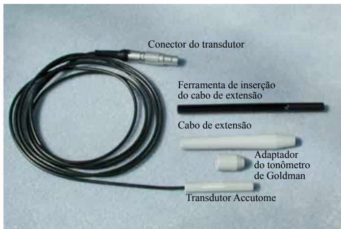
Figura 3-7 Kit do transdutor de ultrassom Accutome (PN 24-4001)
