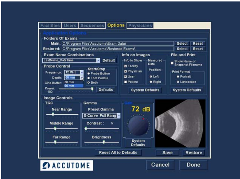
Figura 52 Selección de la profundidad de la sonda
