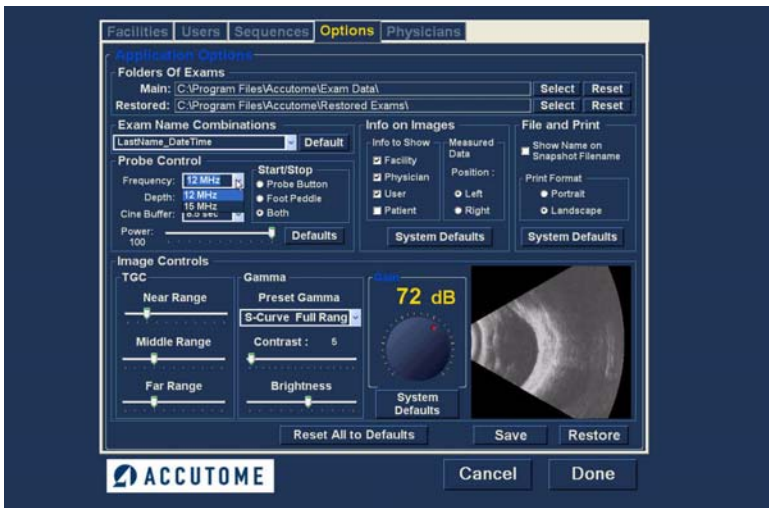
Figura 51 Selección de la frecuencia de la sonda
