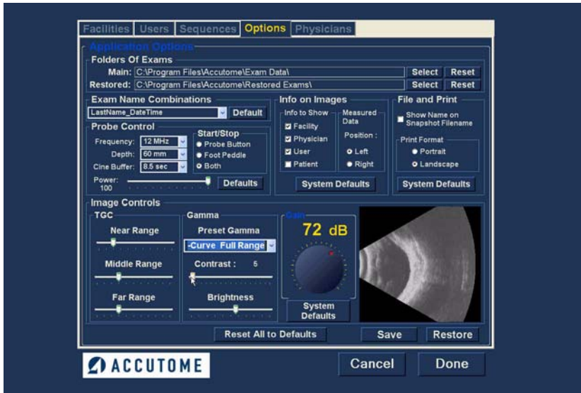
Figura 58 Ajuste del contraste y del brillo
