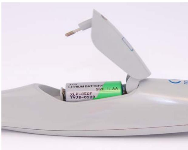
**Figure 3** Insertion de la pile
