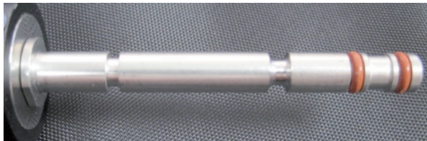
,O'-Ring ist lt. Darstellung einzubauen
