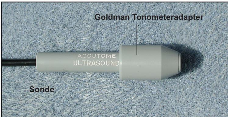
**Abb. 12** Sonde mit Goldman Tonometeradapter
