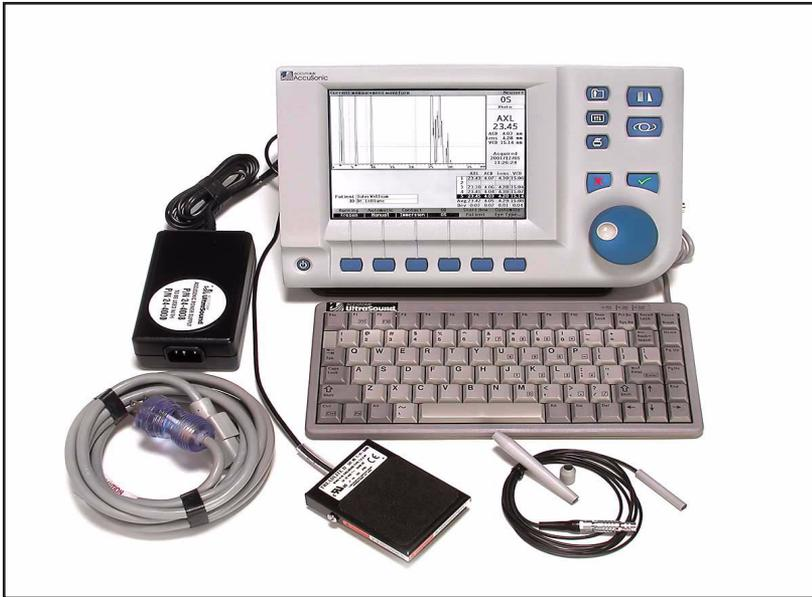
**Abb. 2** *AccuSonic A-Scan-Bestandteile*
