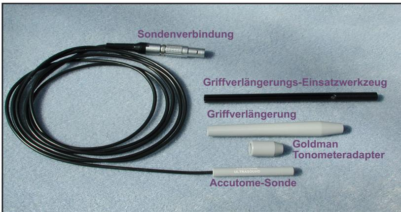
Abb. 9 Accutome-Ultraschallsondenset (PN 24-4001)
