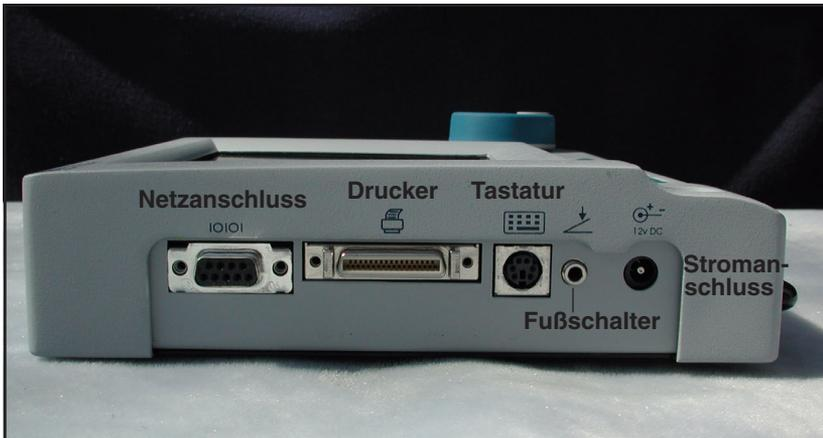
**Abb. 6** Anschlussbuchsen der Bauteile (linke Seite des Instruments)
