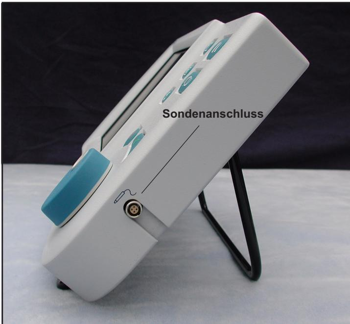
**Abb. 7**      **Sondenanschluss (rechte Seite des Instruments)**
