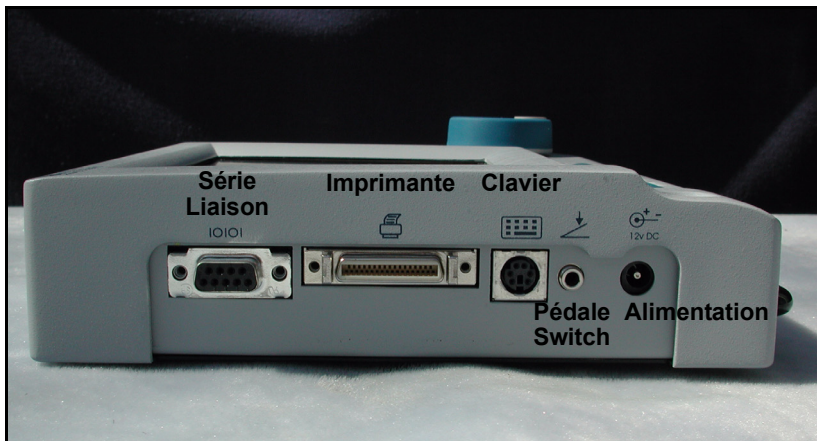
Figure 6 Connecteurs de composants (côté gauche de l'instrument)
