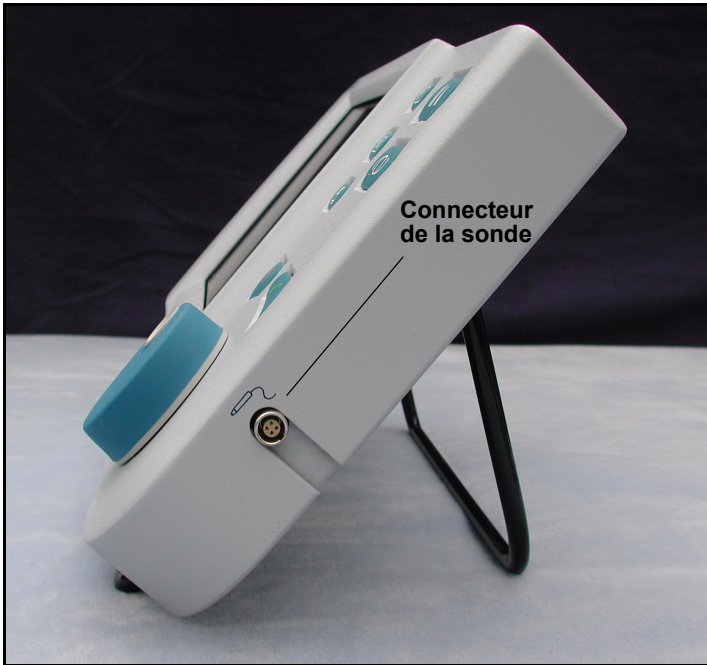
Figure 7 Connecteur de la sonde (côté droit de l'instrument)
