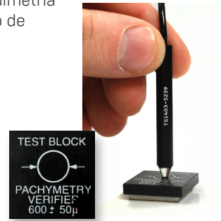
Figura 11.2 - Utilización del bloque de prueba Paquimetría
