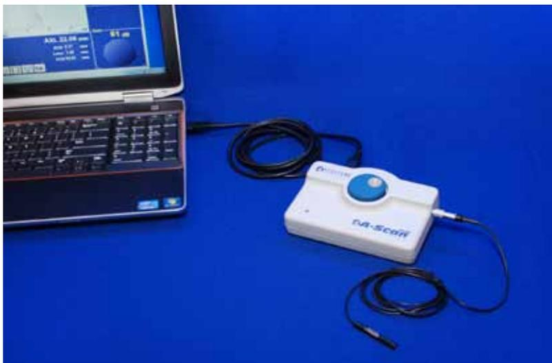
*Abb. 3-10 A-Scan Plus Connect-Steuereinheit über ein USB-Kabel an den Laptop angeschlossen*
