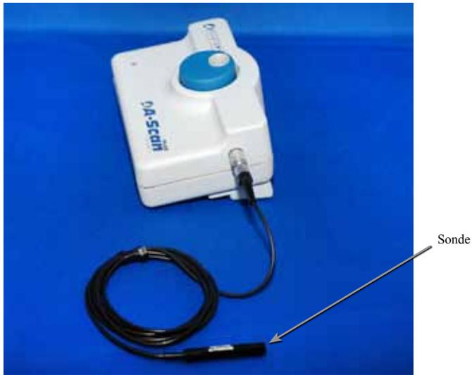
**Abb. 3-2 Angeschlossene Sonde**
