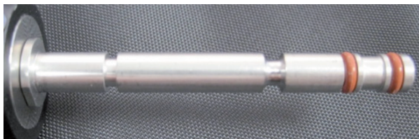
O "O-ring" deve ser instalado como se indica
