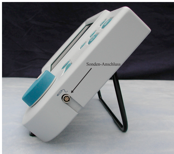
Abbildung 3-5 Sonden-Anschluss (rechte Seite des Geräts)
