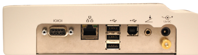
Abbildung 3-4 Komponenten-Anschlüsse (linke Seite des Geräts)
